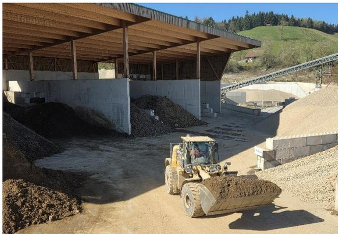
MAKIES hat in Gettnau eine topmoderne **Infrastruktur für Recyclingmaterial** aufgebaut. Gedeckte Lagerhallen oder ein zu hundert Prozent abgedichteter Untergrund ermöglichen dem Unternehmen, Gleisauhub und belastete Böden fachgerecht aufzubereiten und wieder in den Produktionskreislauf einzubringen.
