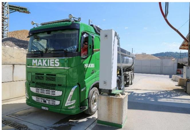
Die neue, **vollautomatische Waage** mit Nummernschild-Erkennung registriert sowohl das Ein-, als auch das Ausfahrtsgewicht der LKWs. Gleichzeitig werden die Ladung und das Fahrzeug fotografiert. Bei der Ausfahrt passieren die Lastwagen zudem eine neue **Radwaschanlage** – für mehr Sicherheit und saubere Strassen.
